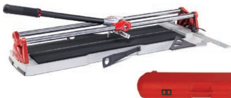
RUBI TALLADOR MANUAL PROFESSIONAL SPEED - 92 MAGNET AMB MALETA 9706677 Longitud de tall: 92 cm. Potència separador 800 kg. Mànegc reforçat amb empenyadura SOFT-GRIP. Topall lateral mil·limetrat per a talls repetitius i esquadra a 45°. Rodeta Ø 8 mm. inclòs.
