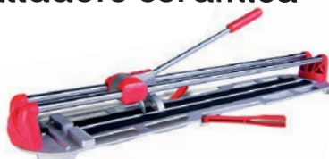
TALLADOR MANUAL CERÀMICA STAR 63 Amb separador mòbil. Amb rodeta de 6mm inclòs. Base amb efecte amortidor. 63 cm de longitud de tall. Gruix de tall 12 mm.
