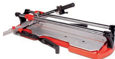
RUBI TALLADOR MANUAL CERÀMICA PROFESSIONAL TX Gruix de tall: 21 mm. Per al tall de Gres Porcellànic i Gres Extrusionat. Separador de 1.200Kg. de potència. Sistema de mesura angular per realitzar talls de 0 a 45°. Topall lateral per realitzar talls repetitius rectes i a 15, 30 i 45°. Rodetes intercanviables de Ø 8 a 22 mm.
